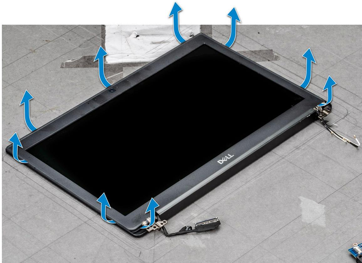
**VAROVANIE:** Vypáčte okraj obrazovky na jednom mieste a postupne pokračujte po celom obvode, kým neodlepíte lepidlo pripievajúce rám obrazovky LCD. Pri páčení postupujte opatrne, pretože lepidlo môže spôsobiť odlúpenie vrstiev obrazovky alebo prasknutie skla.
