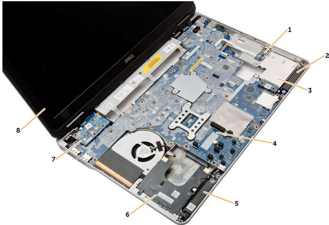
2. ábra. Felülnézet — Eltávolított billentyűzettel és csuklótámasz szerkezettel
