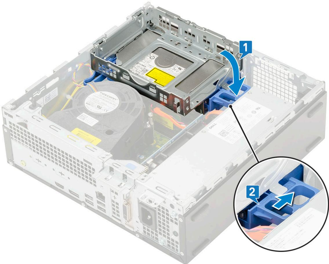
5. Pozați cablurile de date și de alimentare ale hard diskului prin lamea de eliberare a modulului HDD-ODD [1].
