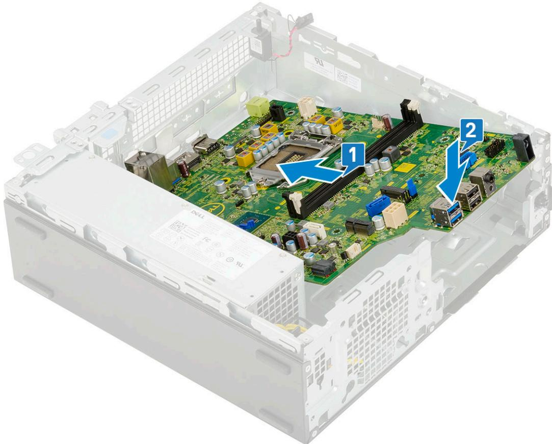
3. Puneți șurubul individual utilizat ca punct de montare pentru unitatea SSD M.2, șurubul separator (#6-32) și cele 5 șuruburi care fixează placă de sistem [1, 2, 3].
