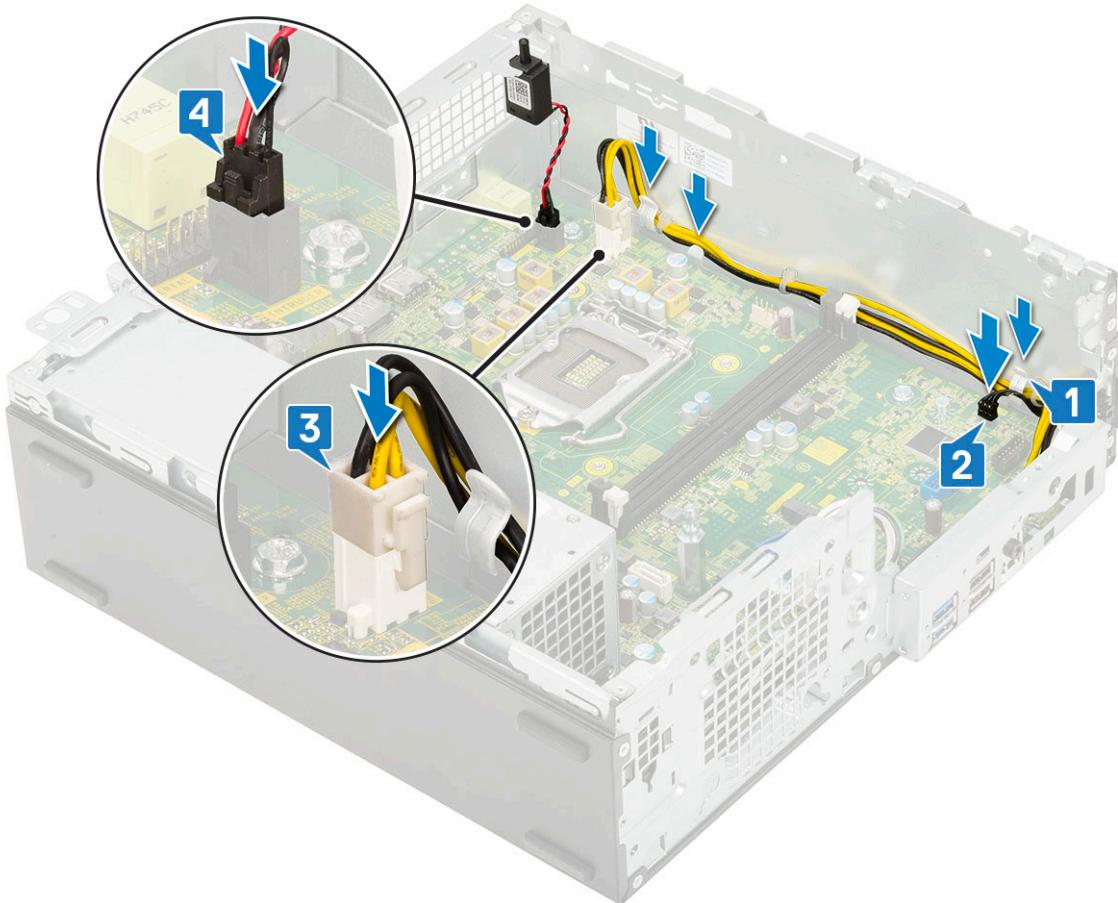
6. Conectați cablul de alimentare, cablul de date al unității optice și cablul de date al hard diskului [1, 2, 3].
