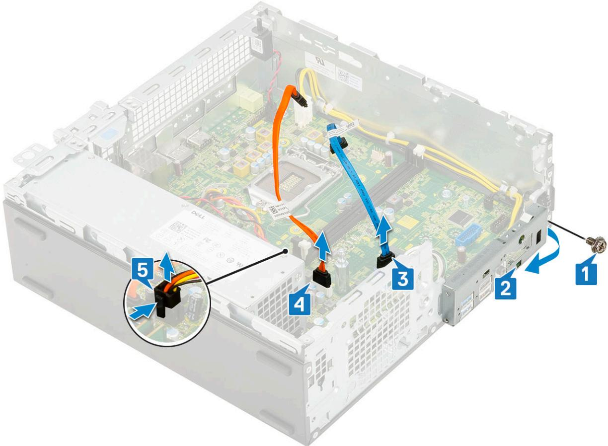
4. Deconectați următoarele cabluri de la conectorii de pe placă de sistem:
