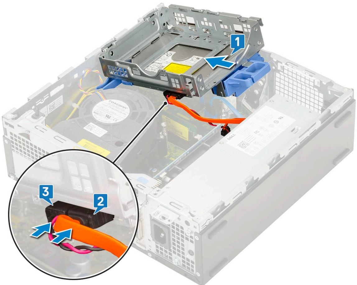
3. Coborâți modulul hard diskului și al unității optice astfel încât să fie poziționat în fanta sa [1].
