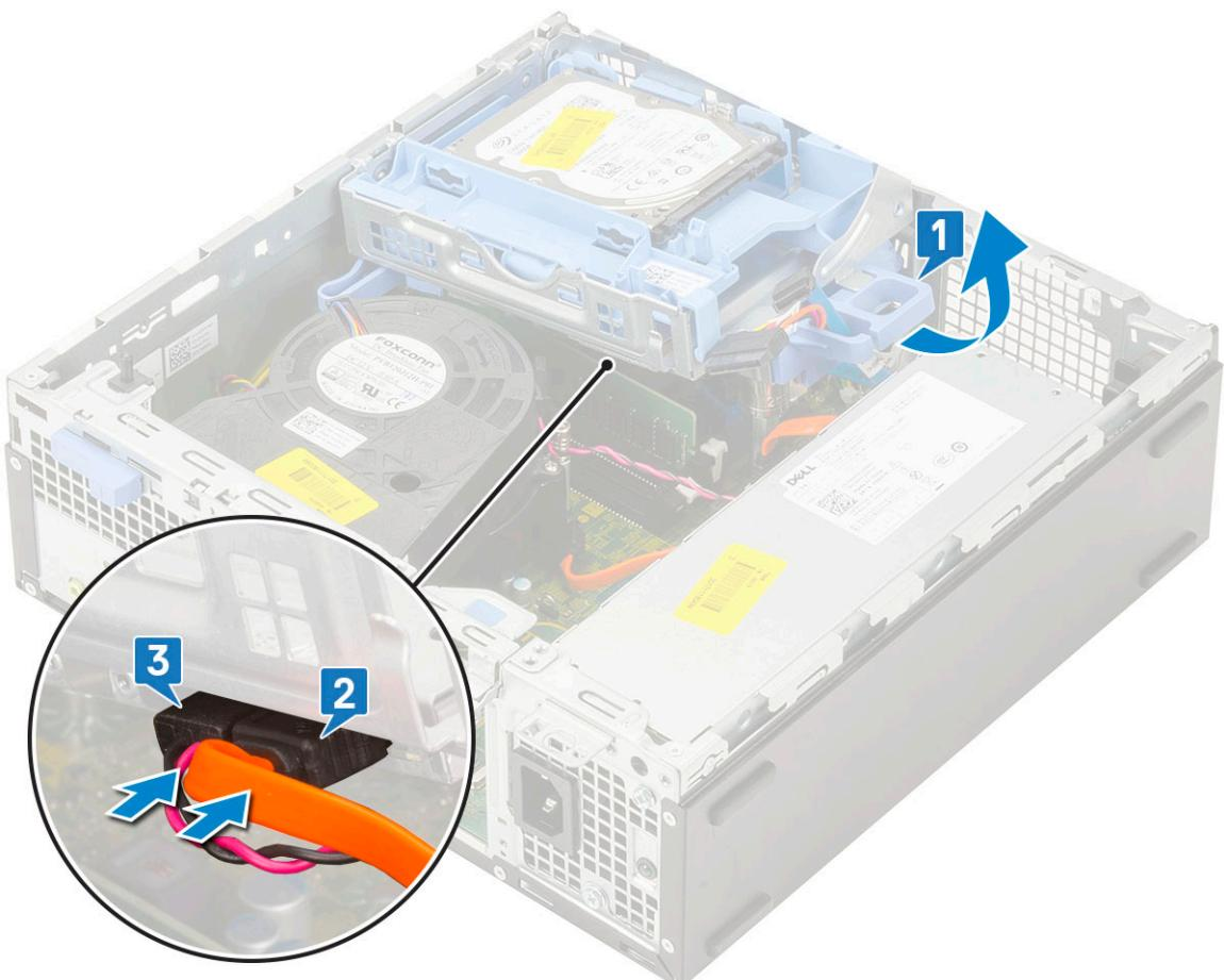
4. Conectați cablul de date și cablul de alimentare al hard diskului de la conectorii de pe hard disk [1, 2].
