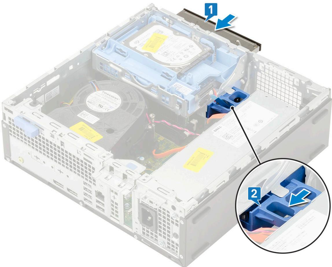
3. Ridicați hard diskul și modulul optic [1], conectați cablul de date și cablul de alimentare al unității optice la conectorii de pe unitatea optică [2, 3].
