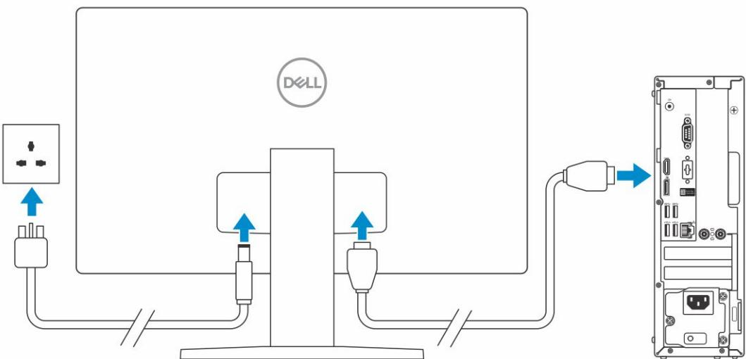
**i | POZNÁMKA:** Pokud jste si objednali počítač se samostatnou grafickou kartou, port HDMI a porty DisplayPort na zadním panelu počítače jsou zakryté. Připojte displej k samostatné grafické kartě počítače.
