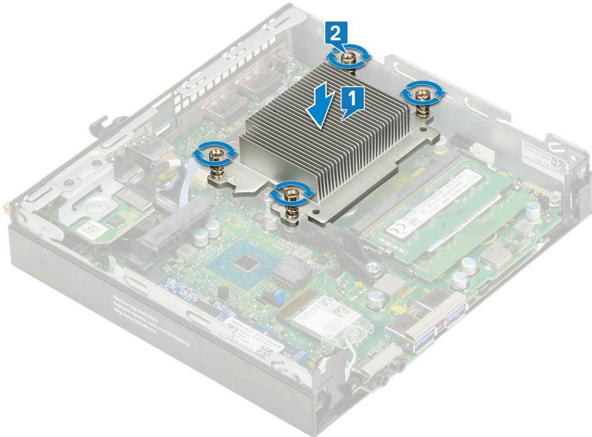
**i | POZNÁMKA:** V systémoch vybavených procesorom s TDP 35 W je zostava chladiča pripojená k systémovej doske troma skrutkami, 65 W procesory pripojený štyri skrutky.
