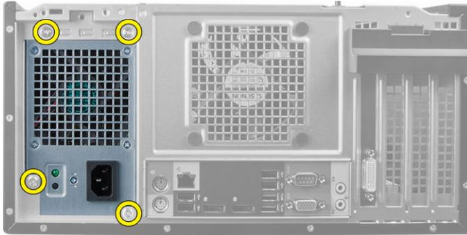
5. Zatlačte na modrou uvolňovací západku vedle napájecího zdroje a vysuňte zdroj směrem k čelní části počítače. Zvedněte zdroj napájení a vyjměte jej z počítače.
