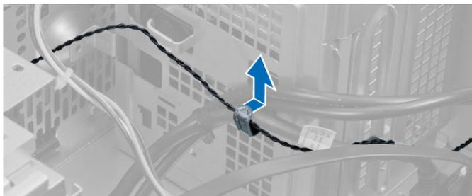
5. Zatlačením na výčnělky na obou stranách uvolněte snímač teploty a vyjměte jej ze šasi.
