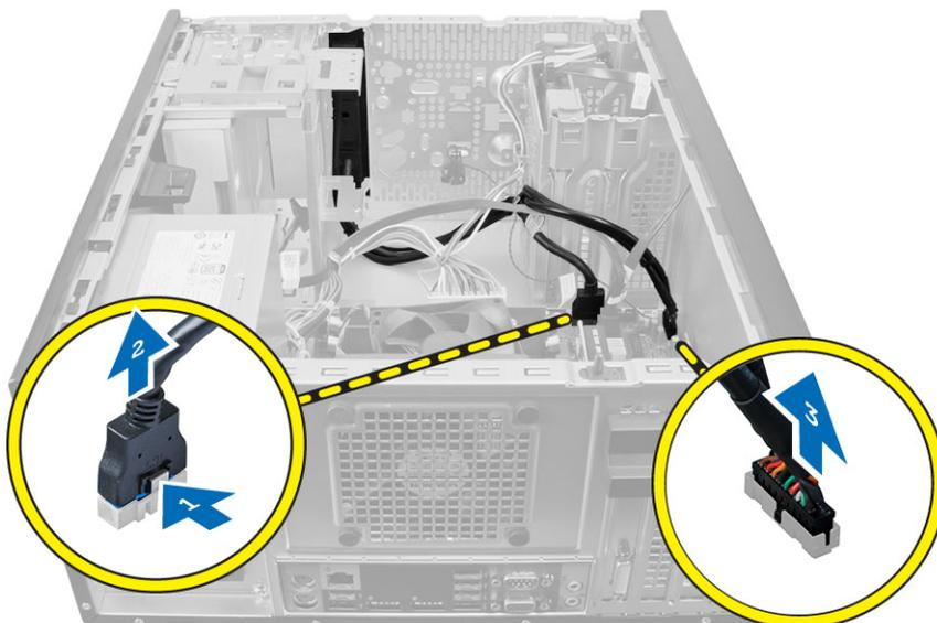
4. Uvolněte a odpojte panel I/O, datový kabel a datový kabel USB od svorky počítače.
