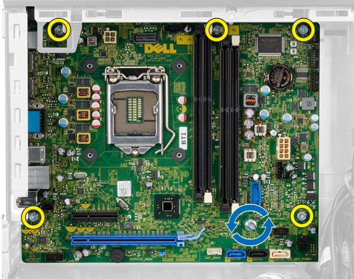
6. Scoateți placa de sistem de pe carcasă.
