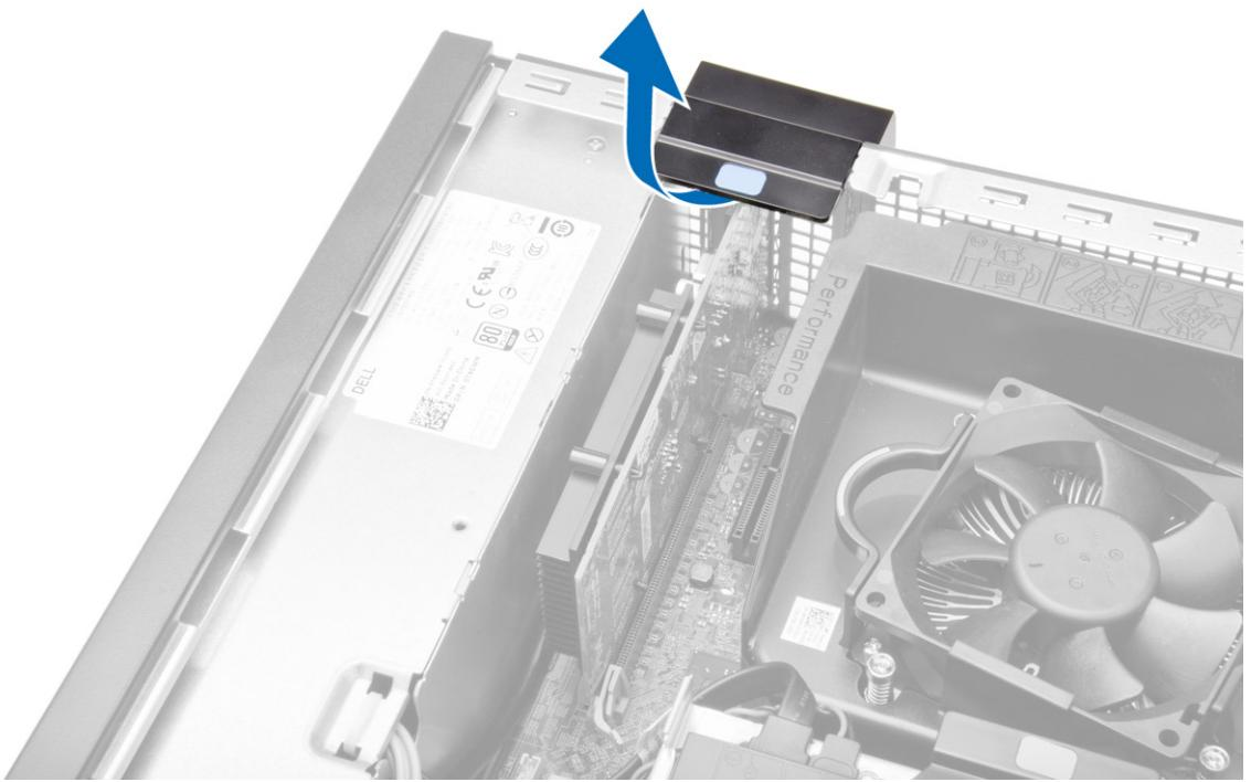
4. Trageți pârghia de eliberare de pe placă de extensie până când eliberați lamela de fixare de pe creștătură din placă. Apoi, scoateți placă prin ridicare din conector și scoateți-o din computer.
