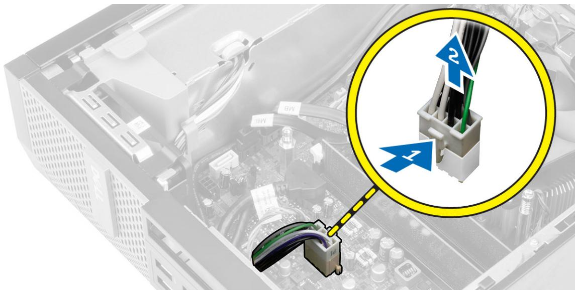
4. Deconectați cablul de alimentare cu 4 pini de la placa de sistem.
