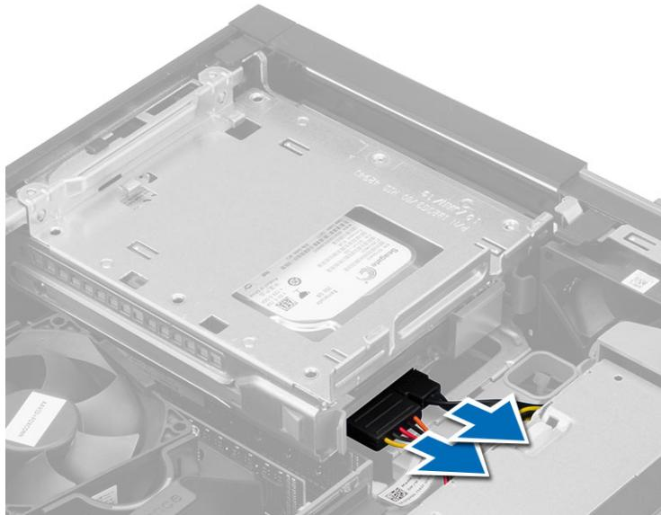
4. Glisați maneta albastră a cutiei hard diskului spre poziția de deblocare și scoateți cutia hard diskului de pe computer.
