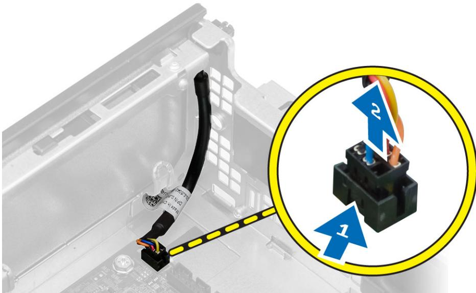
4. Apăsați pe clemele de pe ambele părți ale butonului de alimentare pentru a-l elibera din carcasa și scoateți butonul de alimentare împreună cu cablurile sale de pe computer.
