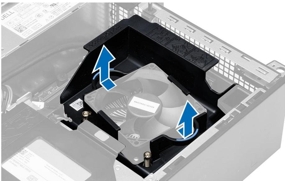
4. Deconectați cablul ventilatorului de la placa de sistem. Desfaceți șuruburile prizoniere care fixează ansamblul radiatorului pe computer și scoateți ansamblul din computer.
