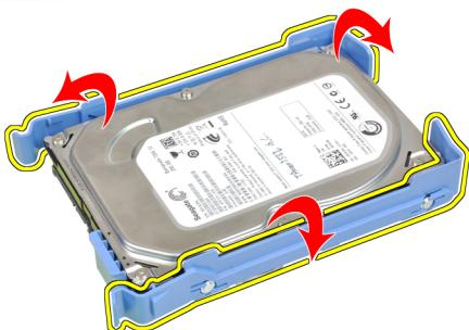
5. Scoateți șuruburile care fixează mini hard diskul pe suportul de hard disk și scoateți hard diskul din suport.
