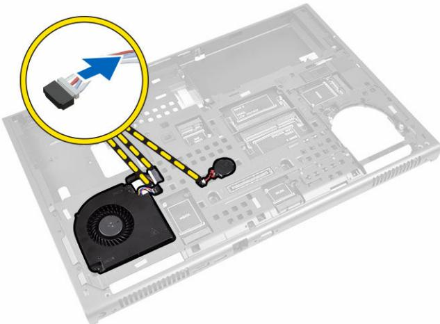
4. Odpojte kabel napájecího konektoru. Vyšroubujte šrouby upevňující základní desku k počítači a zvedněte dolní hranu základní desky pod úhlem 20 stupňů.
