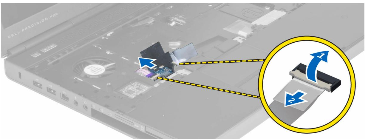
8. Odlepte lepicí pásku upevňující kabel touchpadu k opěrce rukou.
