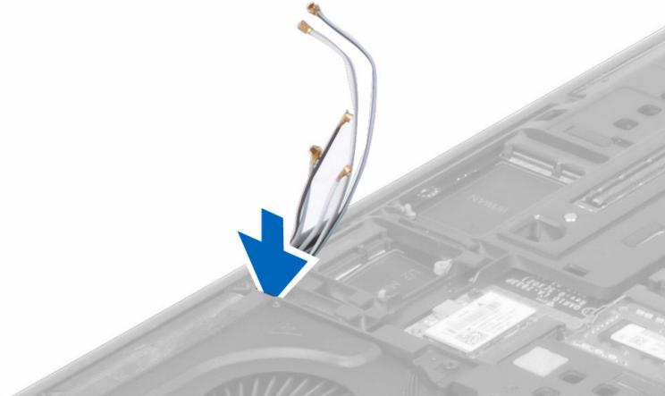
4. Otočte počítač a protáhněte anténní kabely skrz otvor vedení.
