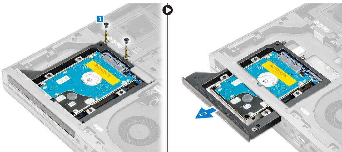
4. Vyjměte šrouby upevňující pevný disk z klece pevného disku. Vysuňte a vyjměte pevný disk z klece pevného disku.
