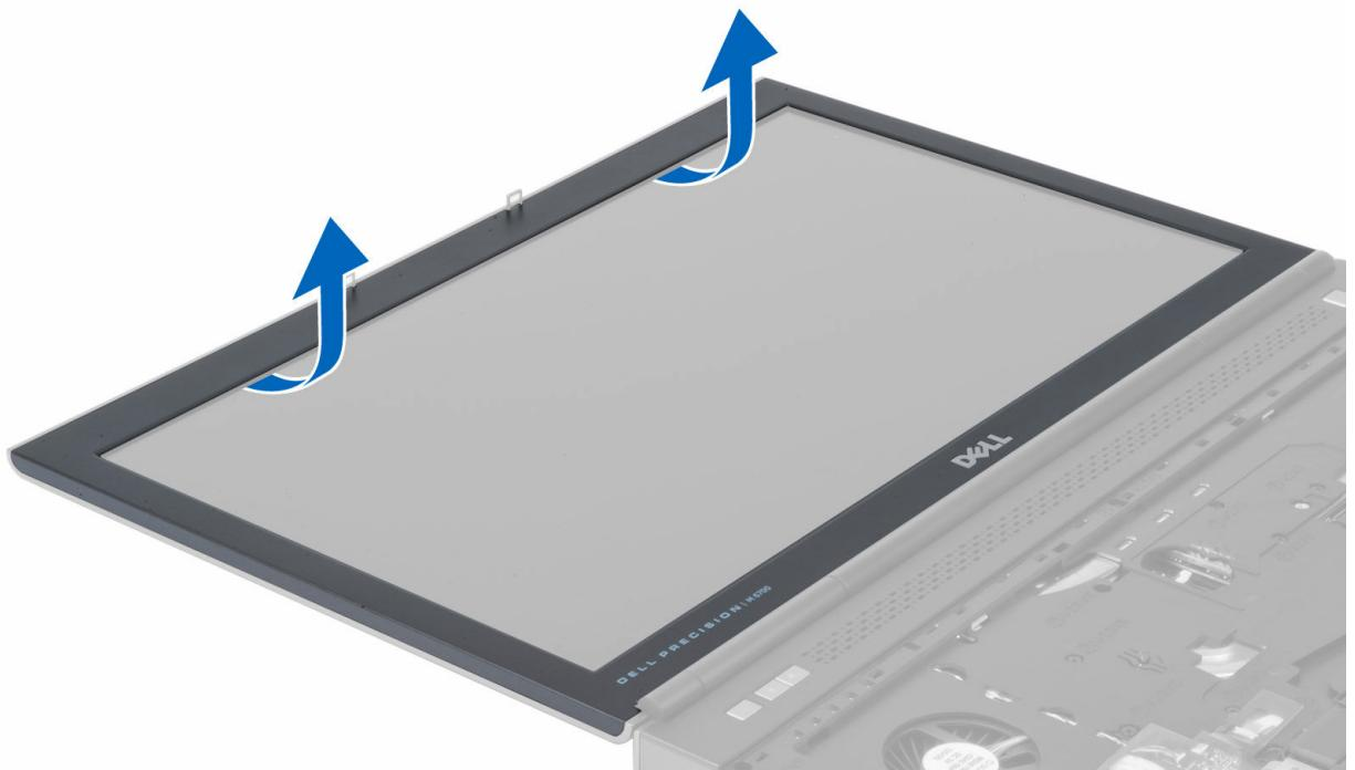
4. Propracujte se okolo boků a horní hrany čelního krytu displeje a vyjměte ho z počítače.
