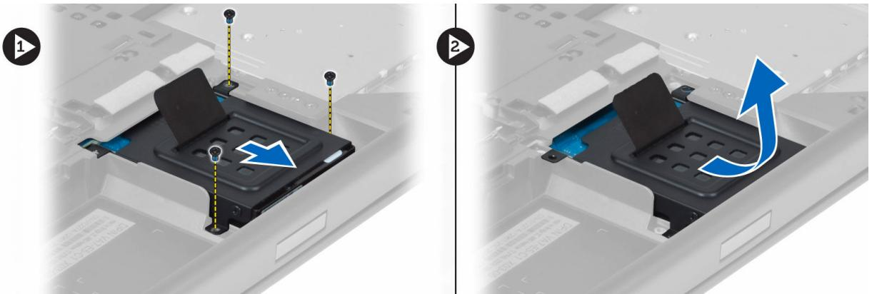
5. Odstraňte šroub upevňující sekundární pevný disk k držáku.
