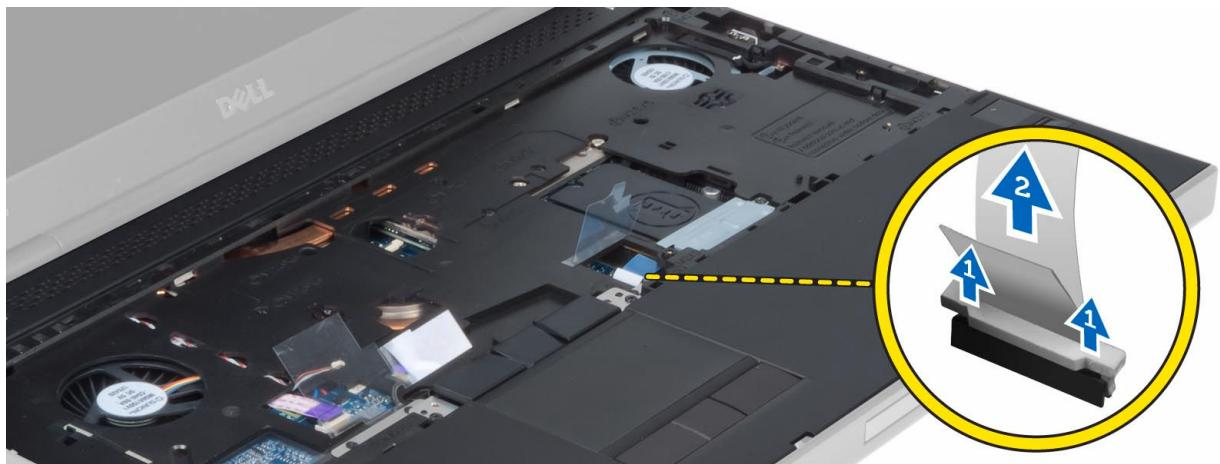
10. Odpojte napájecí kabel tlačítka od základní desky.
