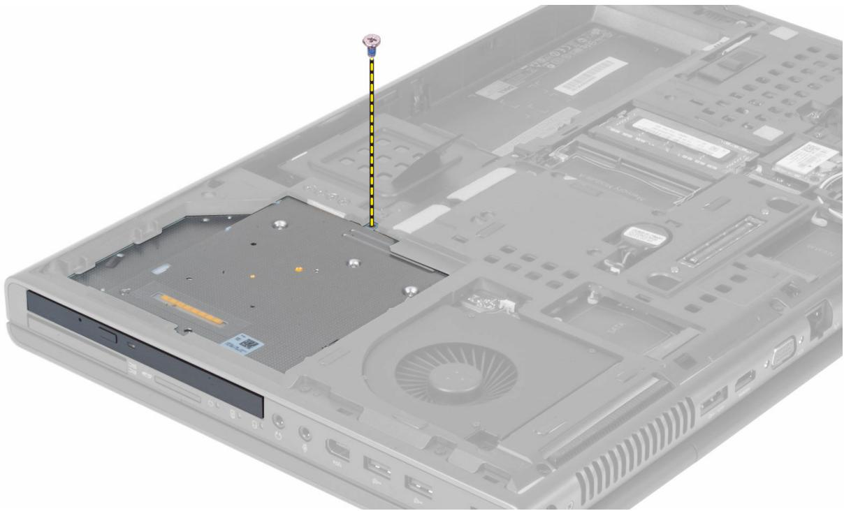
4. Páčením oddělte a vysuňte optickou mechaniku a vyjměte ji z počítače.
